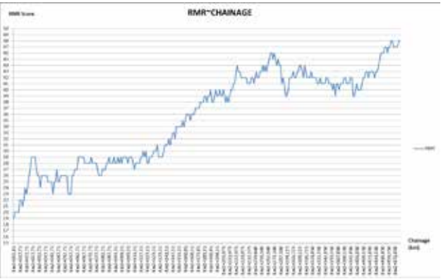
Trục hoành là Lý trình đường hầm tính từ cửa hầm, trục tung là điểm số địa chất khối đá RMR
